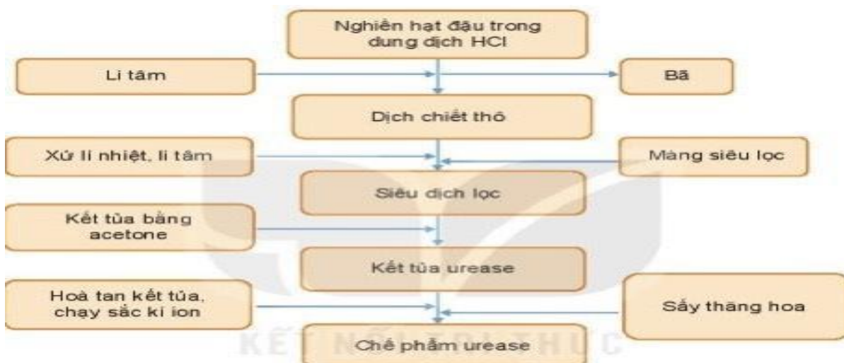
Hình 6.6. Sơ đồ quy trình thu nhận enzyme urease
